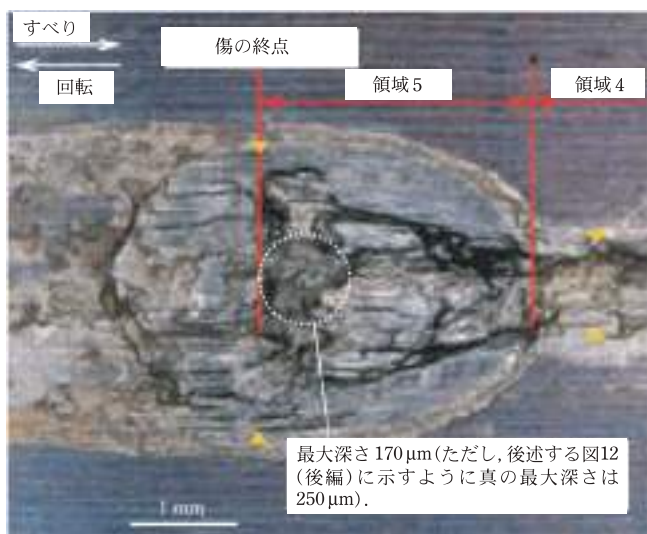
図7 スリーブ表面のすべり傷②の発生・成長過程を領域1～領域5に分類したときの各領域の特徴。
