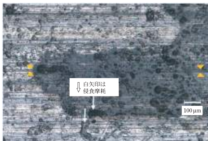
(b) すべり傷②の領域1内のエリアAで観察される侵食摩耗
