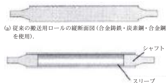
(a) 従来の搬送用ロールの縦断面図 (合金鋳鉄・炭素鋼・合金鋼を使用)。
