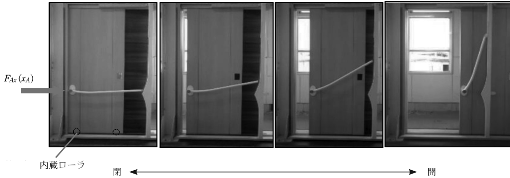
図6 引き戸開閉試験装置の開閉状態。20万回繰返し開閉した結果、ひずみやき裂の発生は認められなかった。
