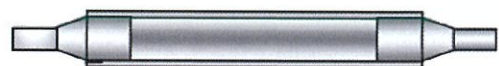
(b) 曲げ荷重に対する検討に用いたセラミック製スリーブロール
