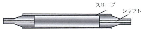
(c) スリーブの焼外し条件の初期検討に用いるセラミック製スリーブロールA
