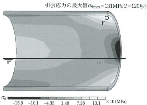
図 19 シャフトなしスリーブ単体の浸漬時の応力分布 (浸漬速度 u = 2 \text{ mm/s} のとき)。
